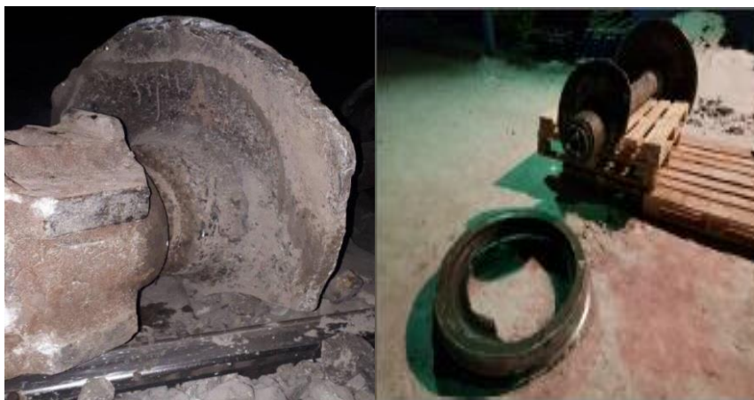
Рис. 5. Излом обода колеса
