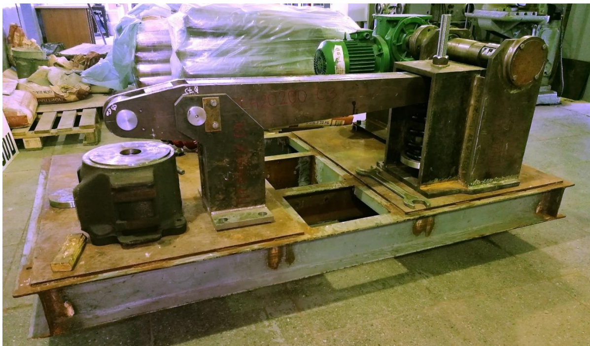
Рис. 3. Стенд для испытания образцов материала на усталостную прочность
