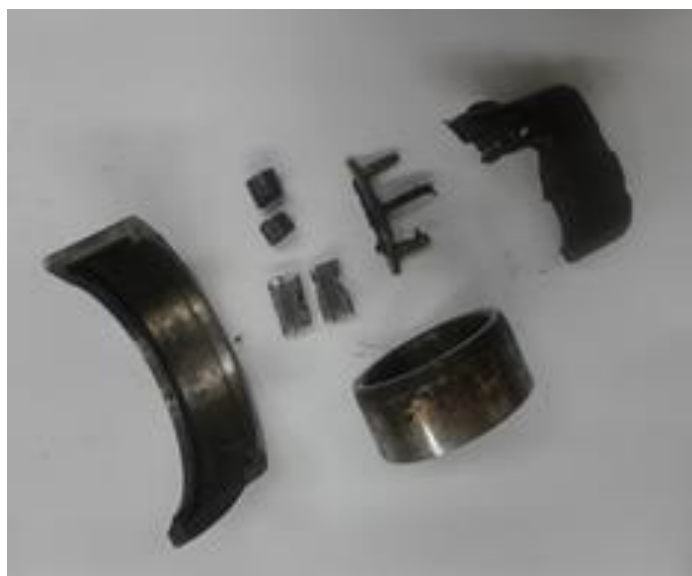
Рис. 1. Фрагмент полного разрушения подшипника
