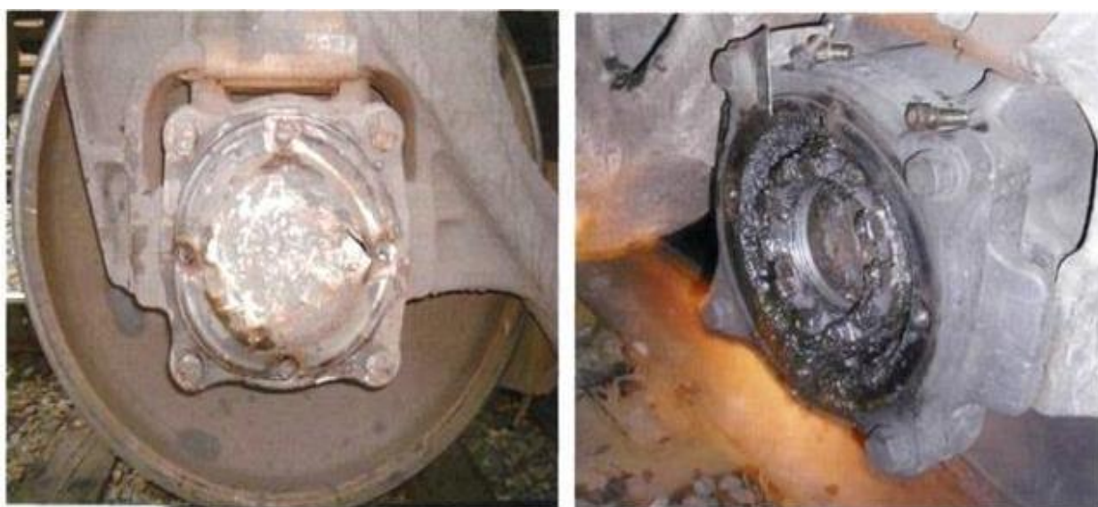
Рис. 2. б. Разрушение торцевого крепления буксового узла
