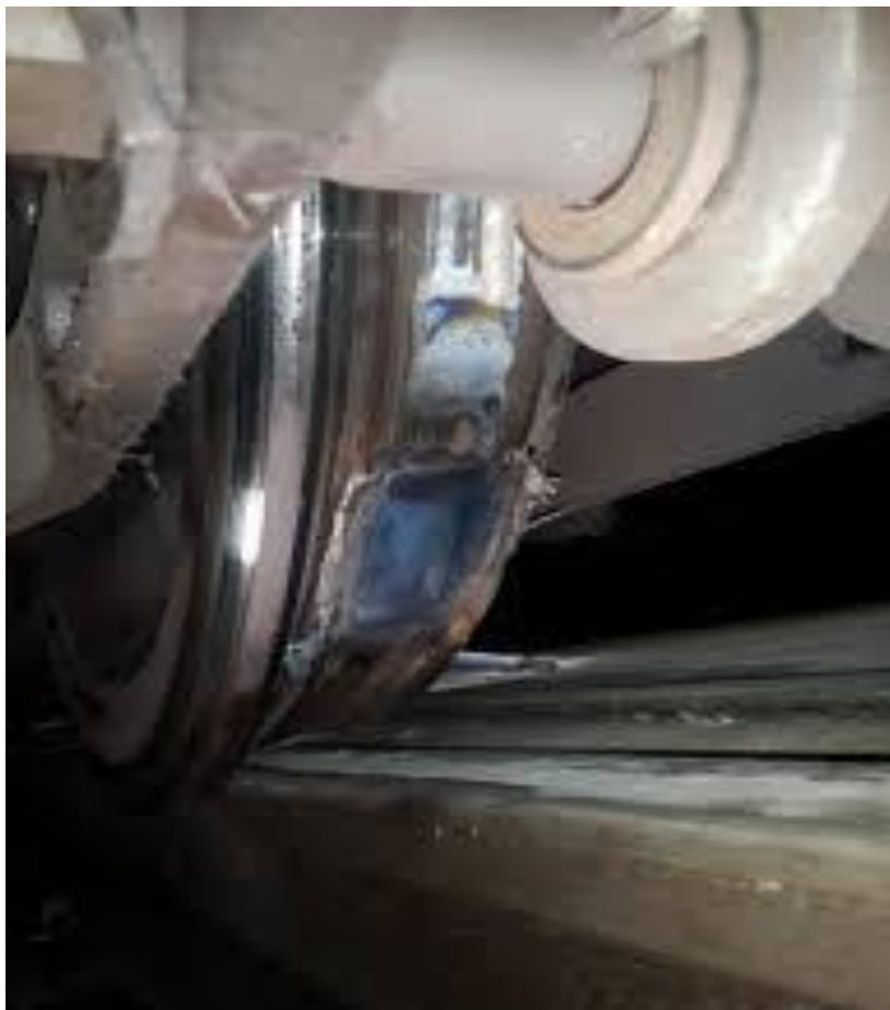
**Рис. 3. Пример ползуна на колесе**
