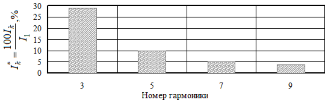
Рис. 3. Спектр гармоник тока электровозов
