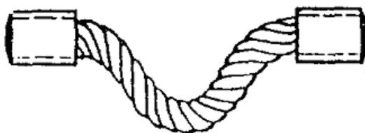
**Рис. 3. Соединитель рельсовый приварной**
