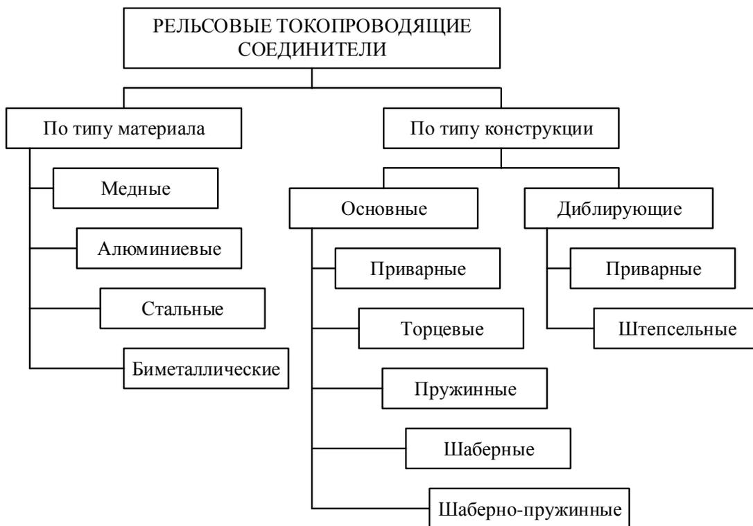
**Рис. 2. Классификация токопроводящих рельсовых соединителей**
