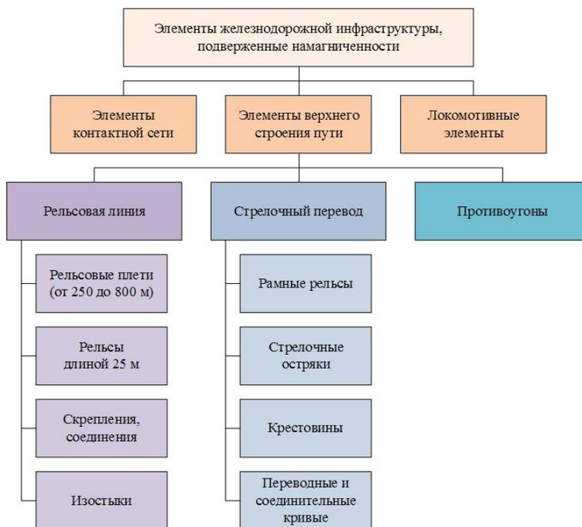
**Рис. 2. Классификация элементов железнодорожной инфраструктуры, подверженных намагниченности**
