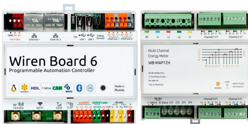
Рис. 1. Внешний вид контроллера Wiren Board 6 и модуля WB-MAP12
