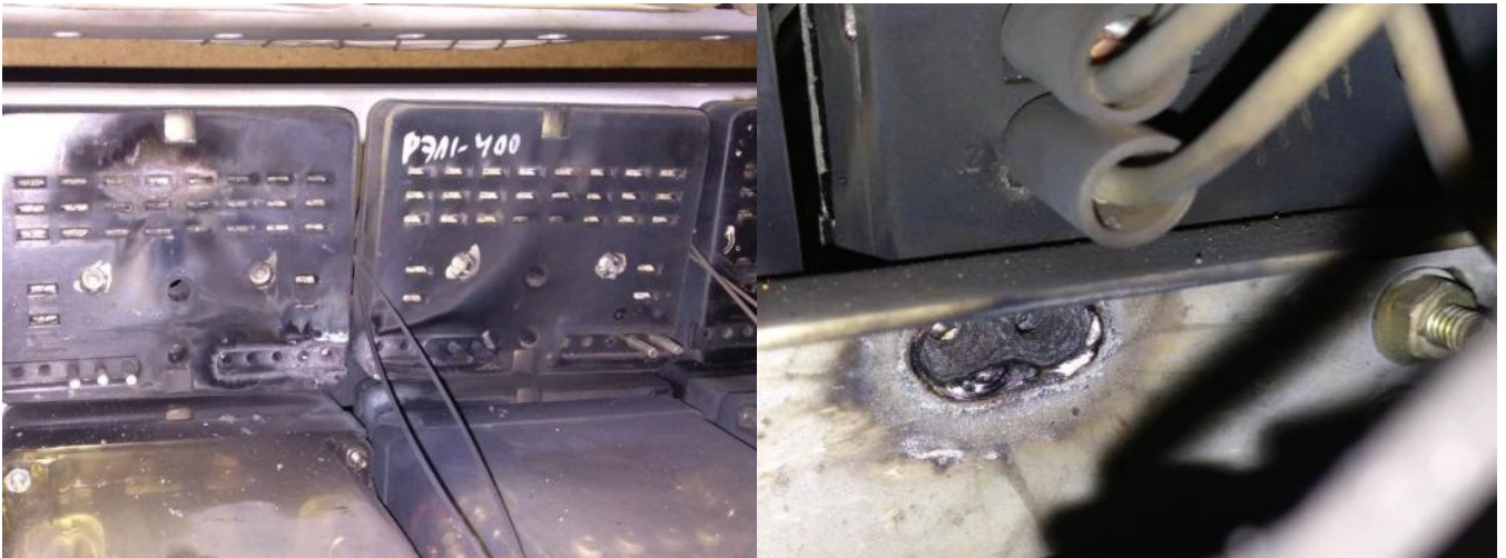
Рис. 3. Пробой платы с линейными цепями 2-х сторонней АБ
