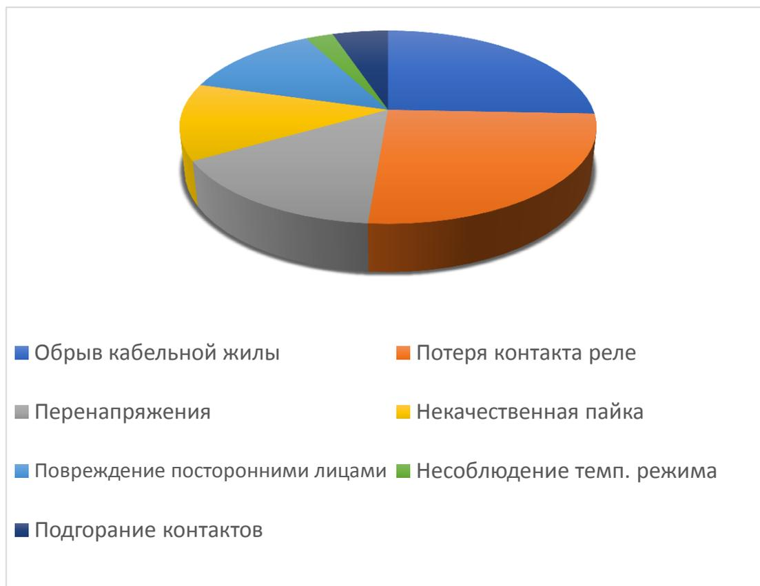
Рис. 1. Анализ причин выхода аппаратуры АТ из строя в период наблюдений с 2014 по 2018 год
