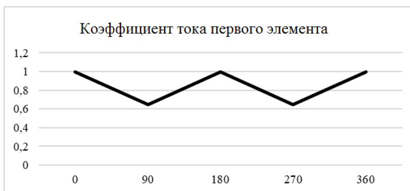
Рис. 5. Амплитудное распределение тока первого элемента
