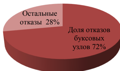
Рис. 1. Доля отказов буксового узла в работе технических средств всех категорий по вагоноремонтным компаниям
