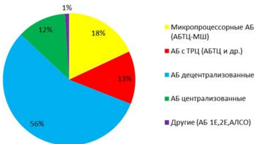
Рис. 1. Диаграмма распределения систем интервального регулирования движения поездов по распространенности на сети железных дорог России
