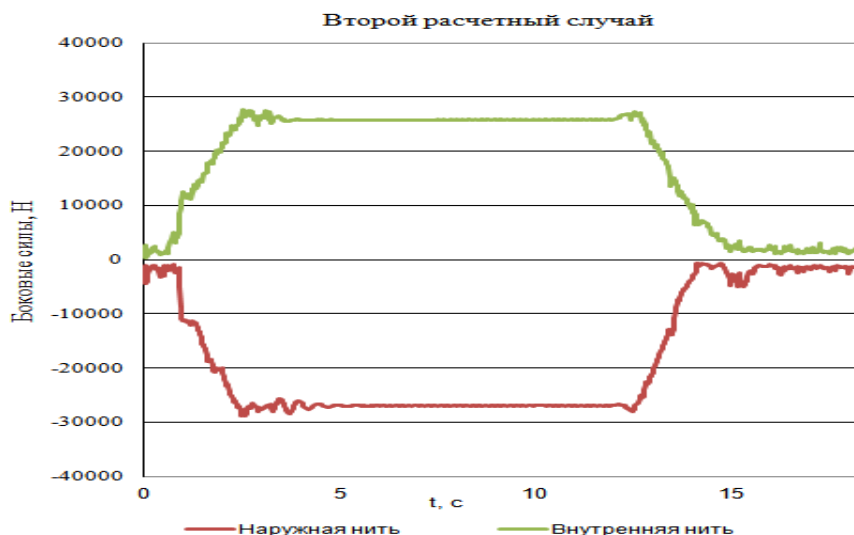
Рис 3. Диаграмма изменения боковых сил при проходе криволинейного участка 2
