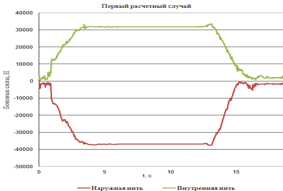
Рис 2. Диаграмма изменения боковых сил при проходе криволинейного участка радиусом равным 600 м
