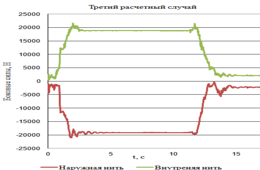
Рис 4. Диаграмма изменения боковых сил при проходе криволинейного участка 3
