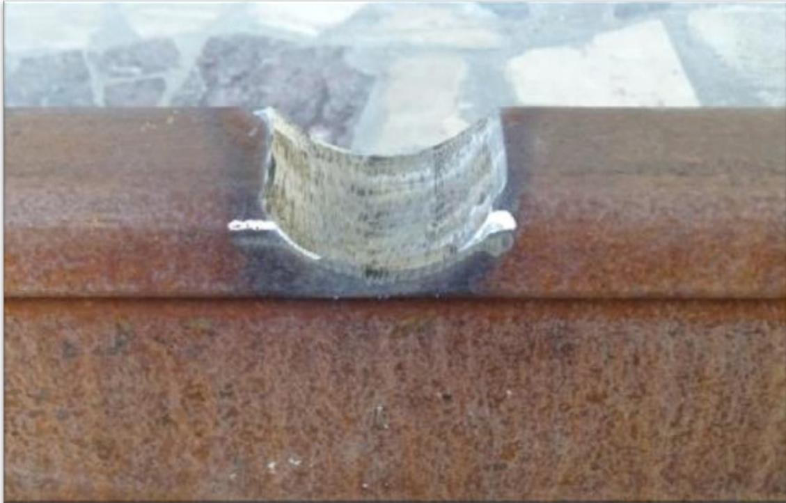
**Рис. 6. Процесс зачистки углошлифовальной машинкой от шлака и остатков стали**
