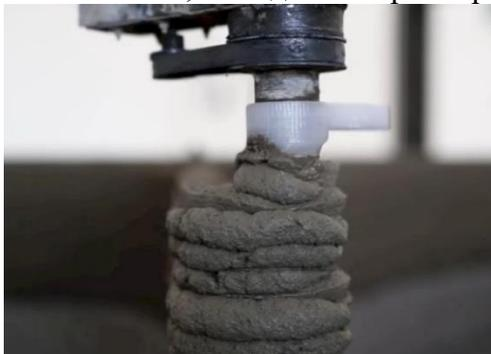
**Рис. 3. Экструзия (выдавливание) специальной смеси**
