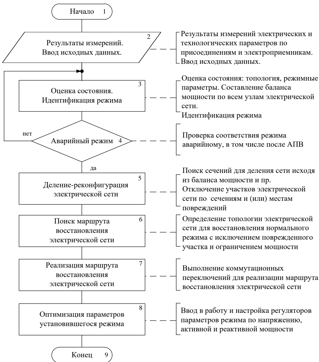
Рис. 5. Алгоритм автоматического восстановления нормального режима в электрических сетях железных дорог
