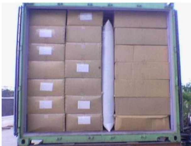
Рис. 2. Пневмооболочка оснащенная клапанным блоком для подачи воздуха
