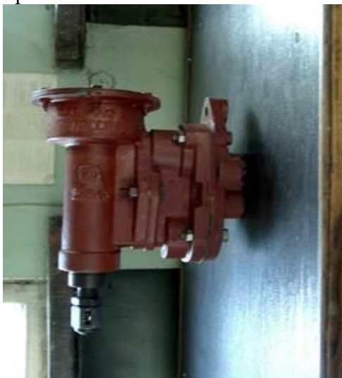
Рис. 2. Общий вид авторежимов №265А-1 и №265А-4: а) авторежим №265А-1; б) авторежим №265А-4
