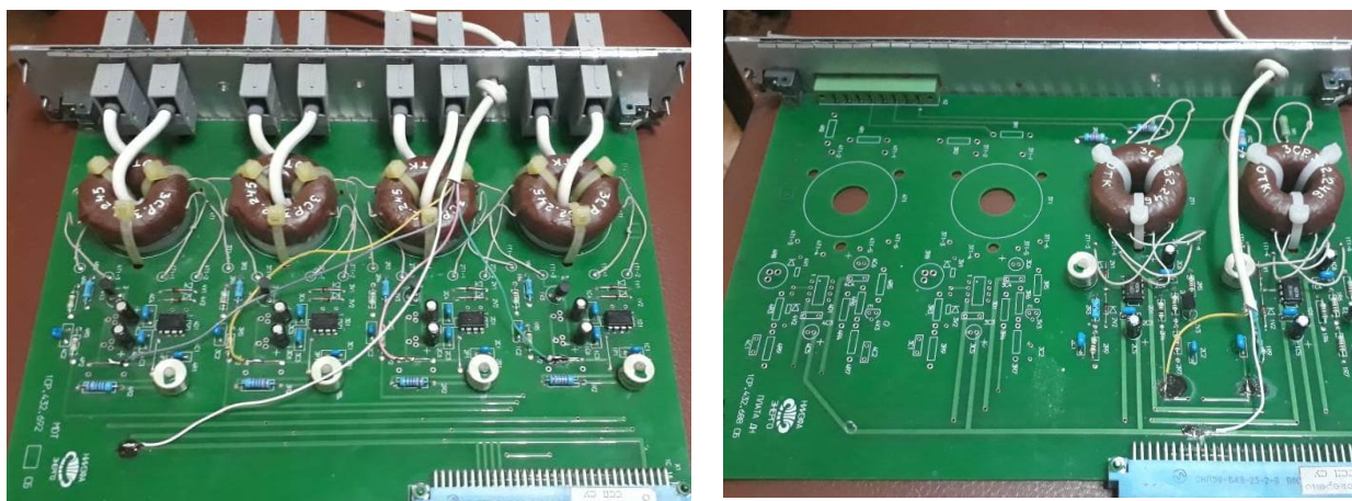
Рисунок 2. Модернизированные под подключение электронного осциллографа модули МДТ и МДН
