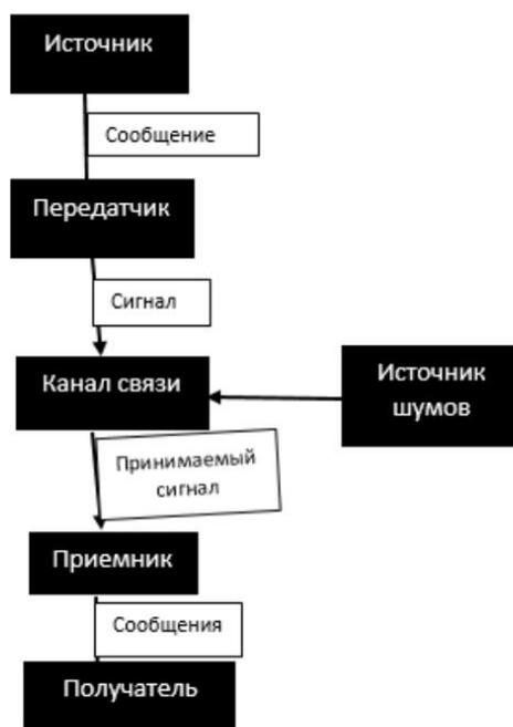
Рис. 1. Схема систем связи
