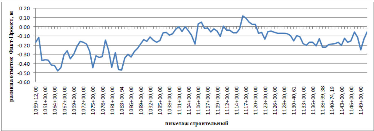
Рис. 3. Анализ высотных отметок продольного профиля головки рельса
