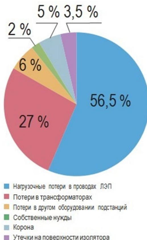
**Рисунок 1 – Структура потерь электроэнергии в электрической сети**
