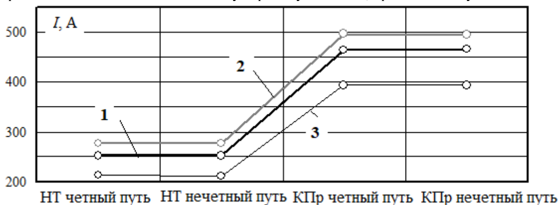
Рис. 4. Токи проводов КП в начале первого участка ТС: 1 – искусственное КЗ; 2 – разнофазное питание от одной ТП; 3 – разнофазное питание от двух ТП
