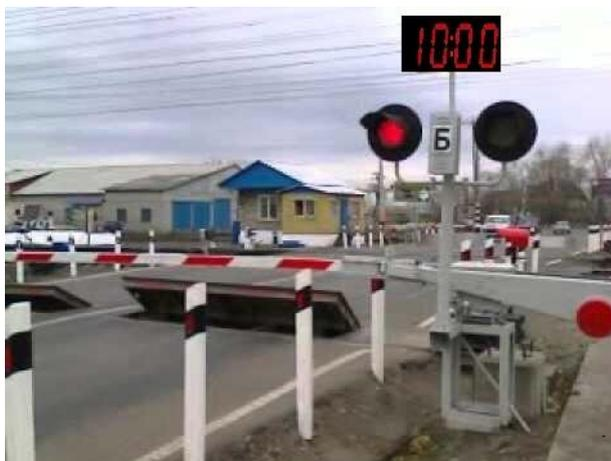
Рисунок 7 – Светодиодное табло с цифровым оповещением об оставшемся времени до закрытия переезда
