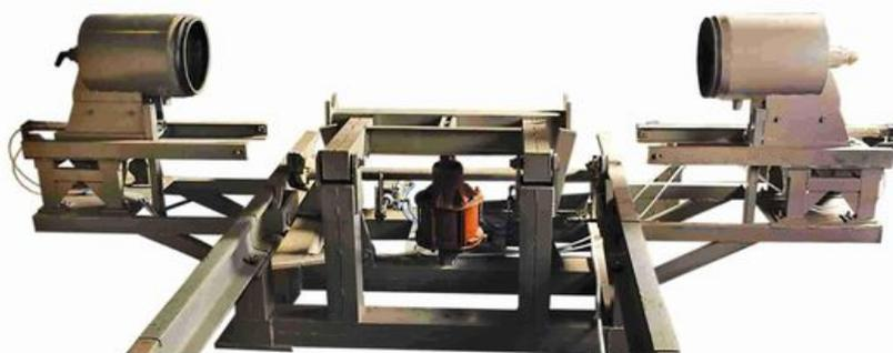
**Рисунок 5- Моечная машина УМК-01 шеек осей колесных пар**
