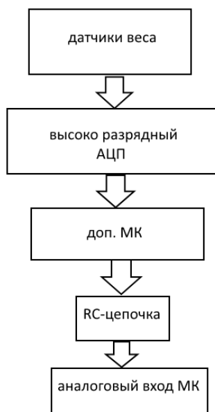
Рис. 8. Структурная схема включения датчиков веса, через дополнительный МК.
