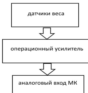
Рис. 4. Структурная схема включения датчиков веса, через ОУ
