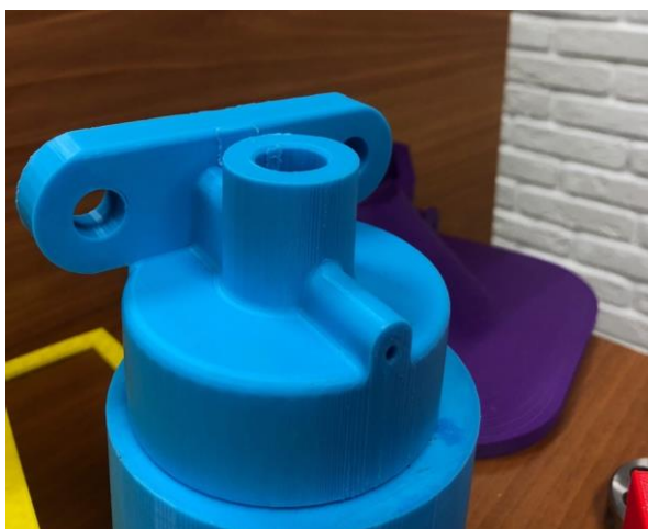
Рис. 4. Корпус стабилизатора крана машиниста после печати
