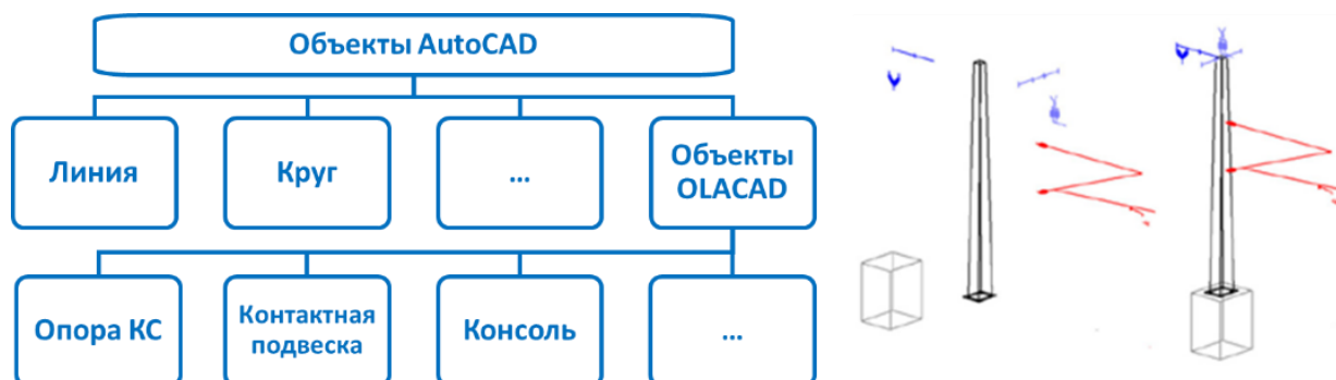
Рис. 1. Схема информационного взаимодействия AutoCAD и OLACAD
