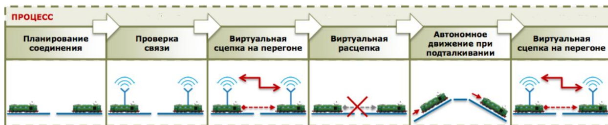
Рис. 2. Схема пропуска поездов на базе «виртуальной сцепки»
