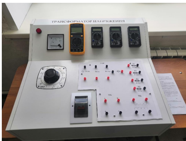
Рис.2. Стенд трансформатор напряжения
