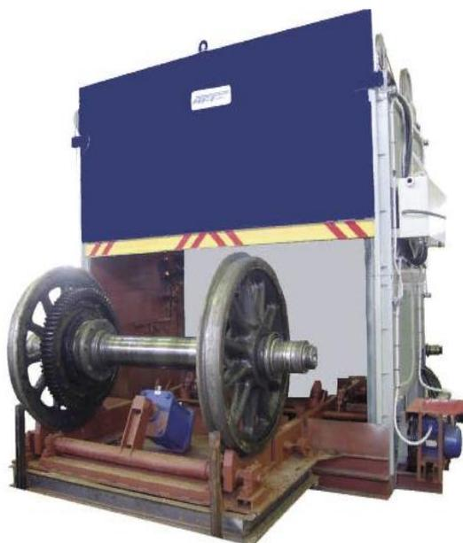
Рис. 2. Машина обмывки колесных пар
