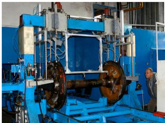
Рис. 3. Бесконтактное измерение геометрических параметров колесных пар на станках
