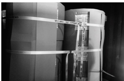
Рис. 2. Технология крепления полиэстеровой лентой грузов цилиндрической формы, при перевозке в 40 футовом контейнере
