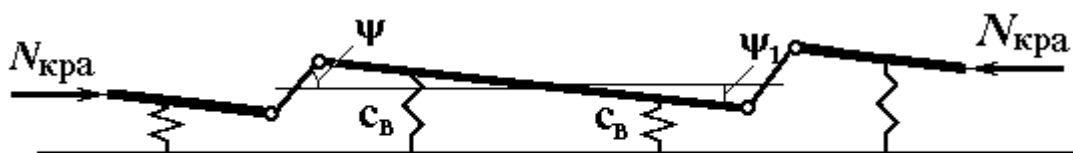
Рис. 2. Форма потери устойчивости вагона от выжимания продольными силами для порожнего вагона
